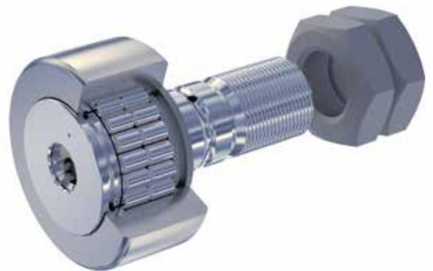
Le dimensioni di montaggio, per le taglie equivalenti, sono le medesime del GC..SW. La soluzione a rulli invece dei rullini riduce lo spessore dell'anello esterno e il numero di rulli volventi. Si riduce il carico massimo ma aumenta la capacità dinamica della rotella.
